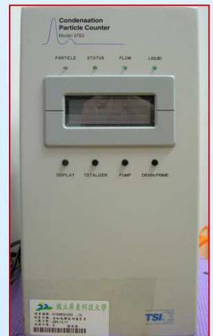
超細氣膠監測儀裝置
